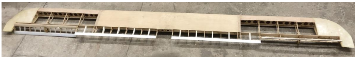
Рис.3.3.2. Виготовлена консоль крила
