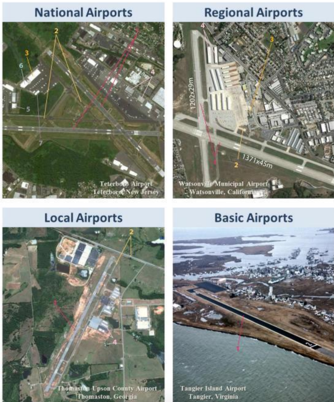
Рис. 14 - (1) - ЗПС; (2) - допоміжні дороги, асфальтовані; (3) - термінал для прийому пасажирів; (4) - ангари; (5) - диспетчерська вишка; (6) - база обслуговування ЛА; (7) - вантажне сховище/склад;
