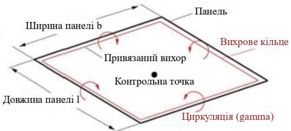
Рис.11. Зображення однієї панелі з її вихровим кільцем і контрольною точкою Для кожної панелі вихрове кільце слідує за його межами, і вихори обертаються навколо цього кільця (див. рис.11) Ці вихори викликають швидкість у
