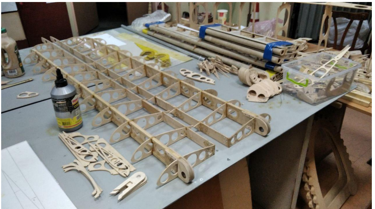
Рис.66 Суха збірка крила
