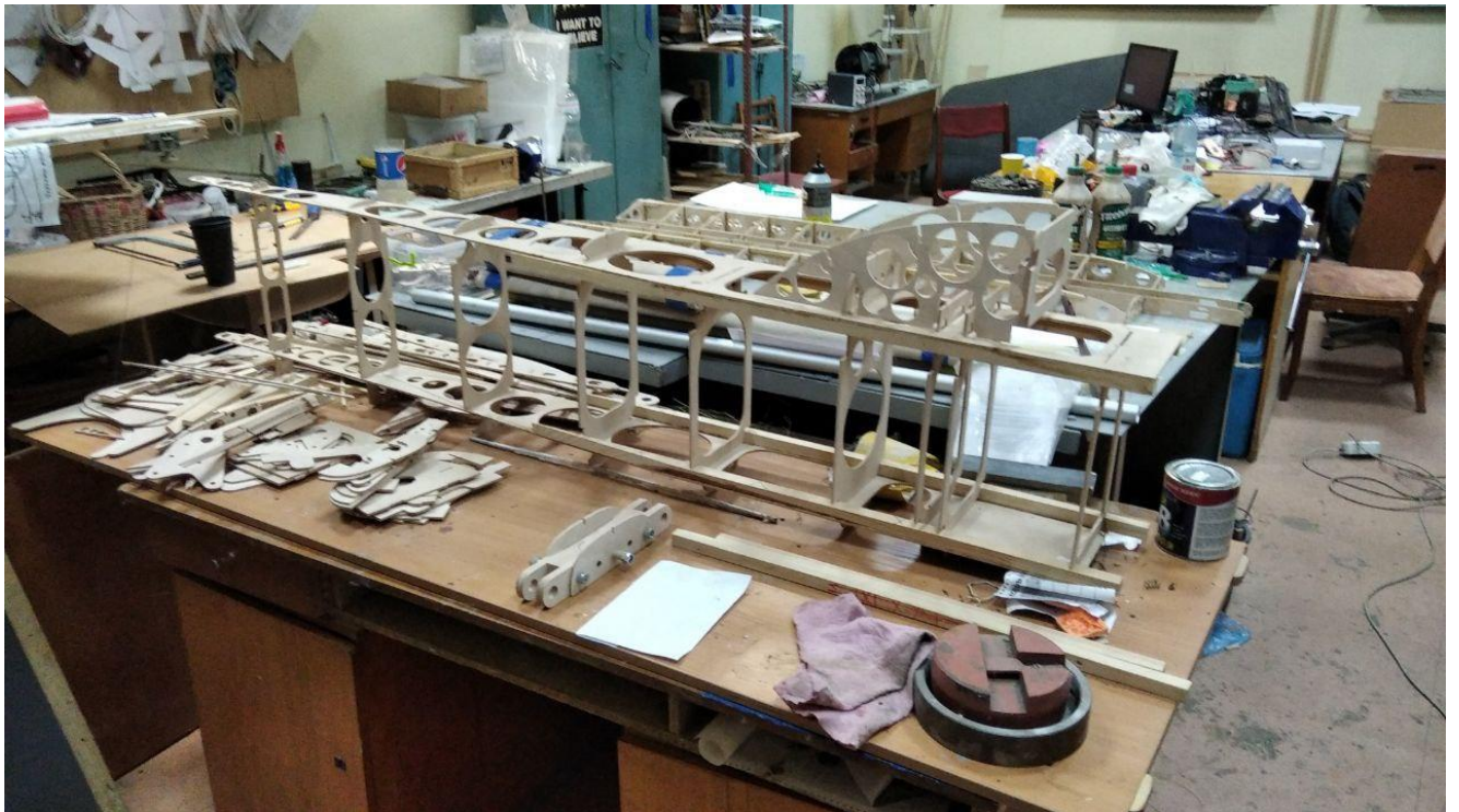
Рис.65 Суха збірка фюзеляжу
