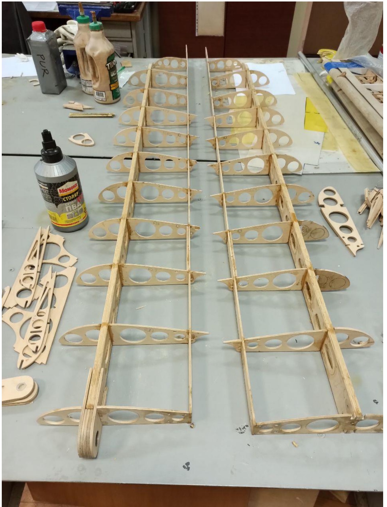
Рис.67 Суха збірка крила
