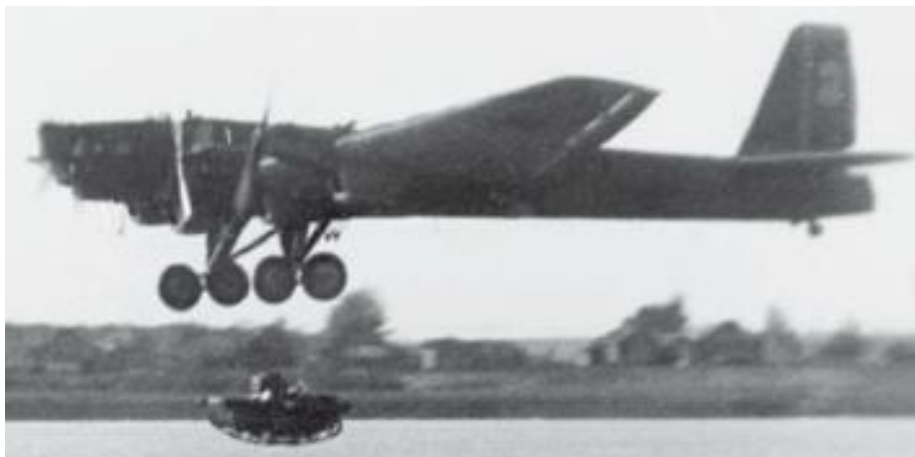
Рис.1.2.2. Скидання плаваючого танку Т-37 з літака в польоті
