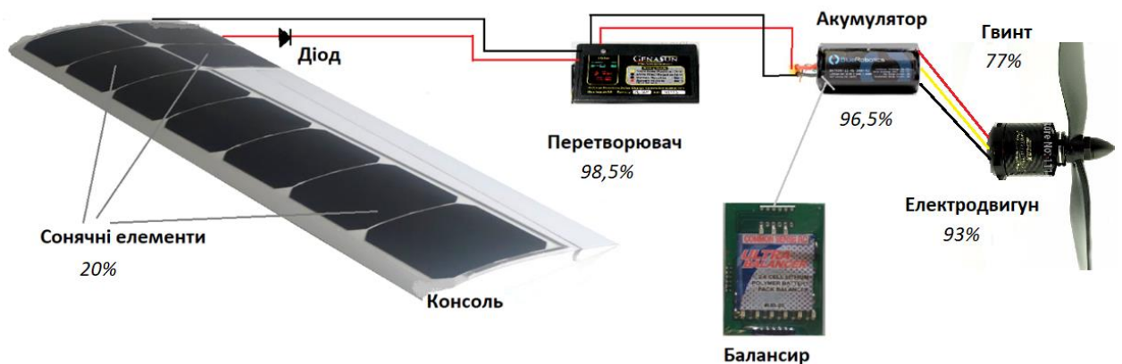
Рис. 6.1. Підключення електроніки з указаними ККД елементів
