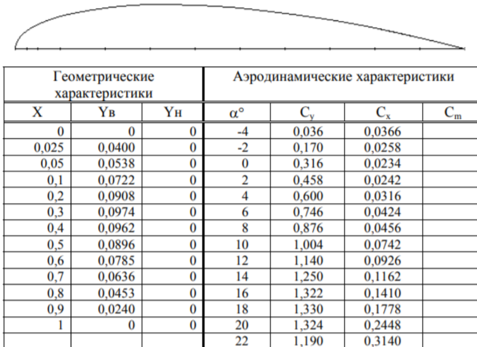
Рис. 8.2. Плаз профілю ЦАГИ-719 [4].
