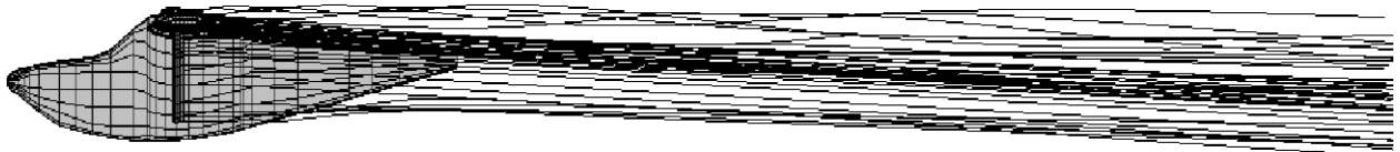
Рис 4.3.5. – 4.3.7 Види моделі з варіантом компоновки підкоса 3.0 та змодельованою вихровою пеленою
