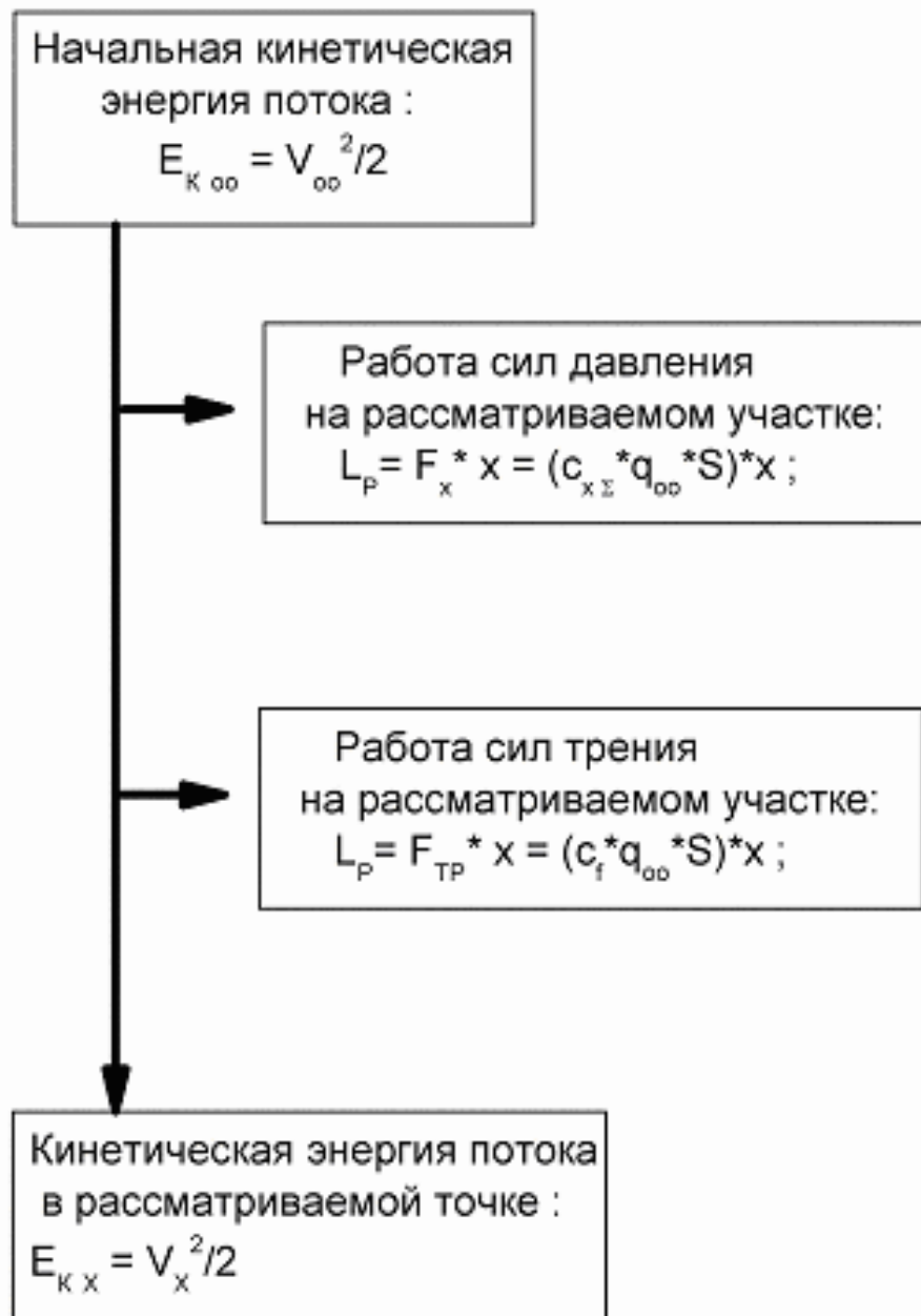
Рис. 3.2 Схематичне зображення витрати кінетичної енергії при адіабатичному русі частинки.
