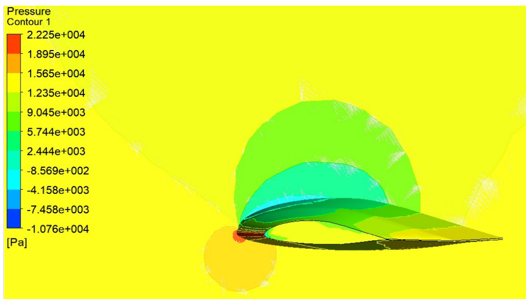
Рис 5.8 Розподіл тиску в області перерізу крила літака
