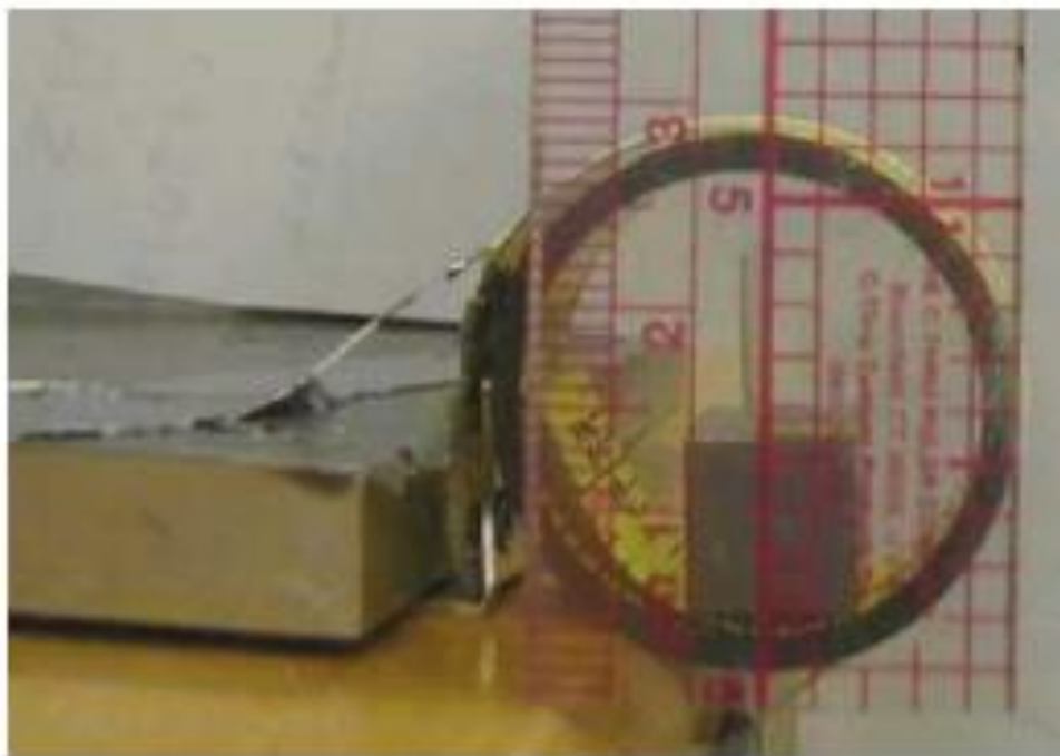
Рис. 1.10 Експериментальний зразок гравітаційного стабілізатора КА CubeSat в згорнутому вигляді (пасивна система)
