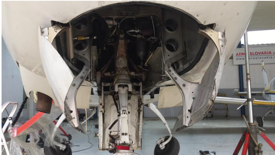
Рис. 1.7 Механізм складання передньої стійки шасі Cessna Skymaster 337
