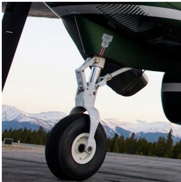
Рис. 1.14 Передня стійка шасі Cessna Caravan
