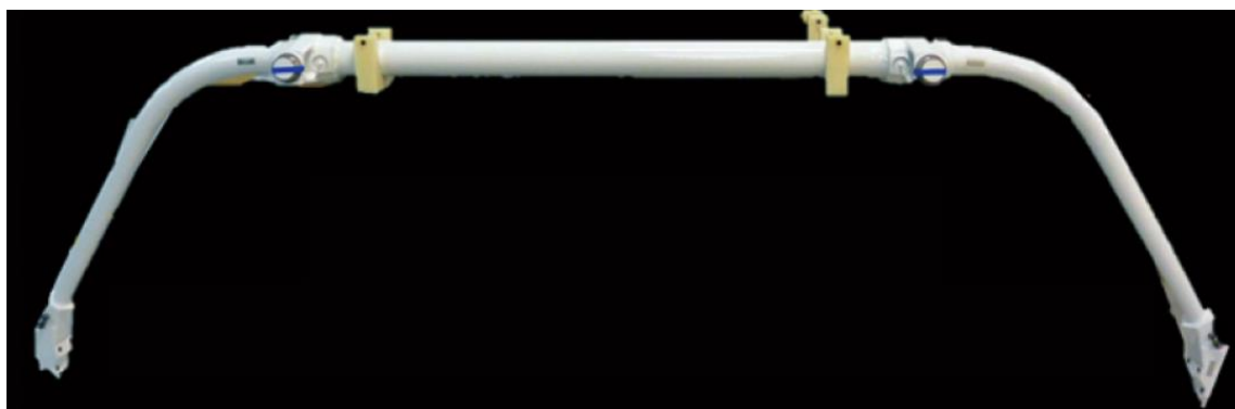
Рис. 1.15 Ресора основної стійки шасі Cessna Caravan
