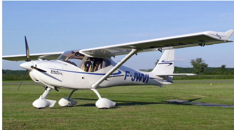
Рис. 1.2 Схема конфігурації шасі із передньою опорою.
