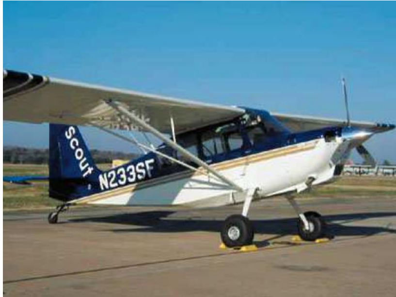
Рис 1.1 Традиційна схема шасі зі звичайним хвостовим колесом
