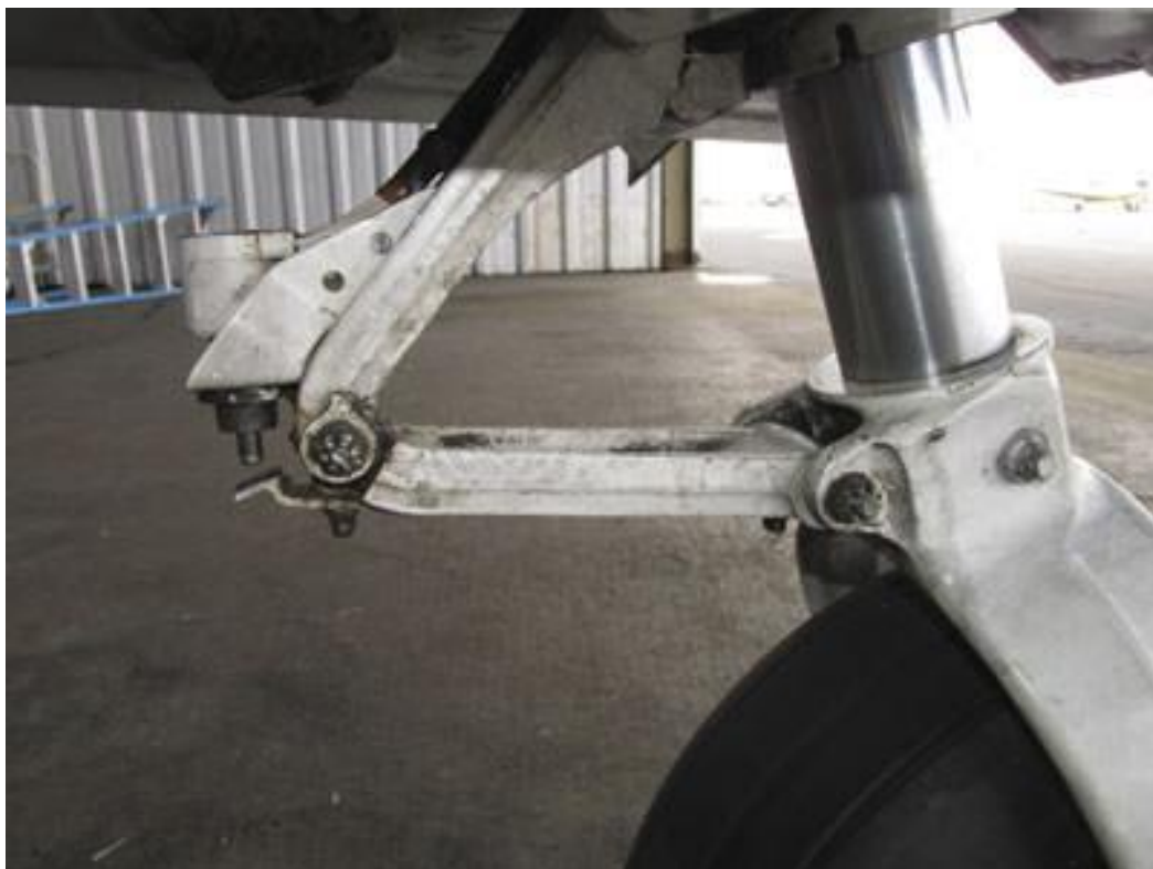
Рис. 1.8 Передня стійка Cessna Skymaster 337
