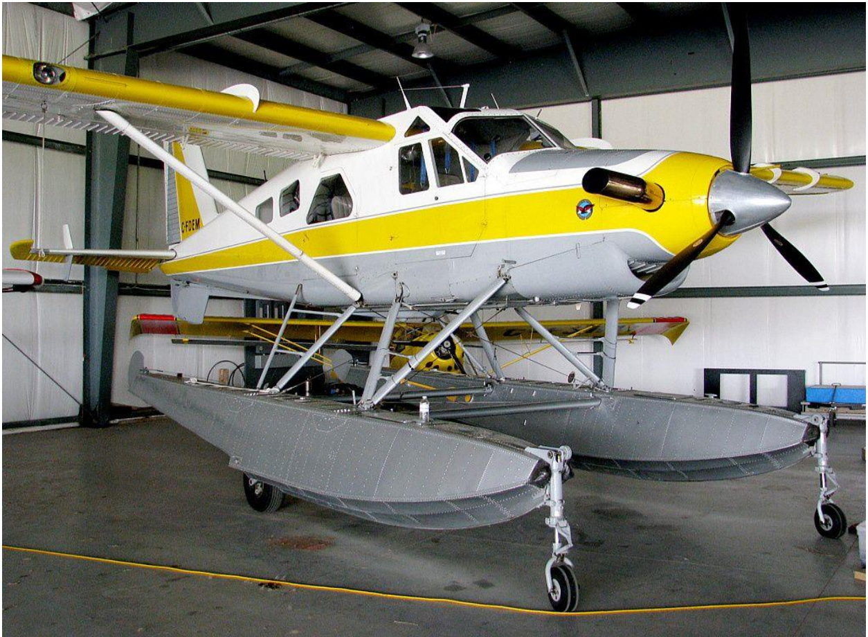
Рис. 1.12 Гібридні шасі DHC-2 Beaver
